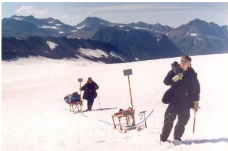
Рис. 12. Локатор ВИРЛ-2. Применялся в 1999 и 2000 годах для зондирования ледника Альдегонда на Шпицбергена и ледников Джонсонс Хард на острове Ливингстон.
