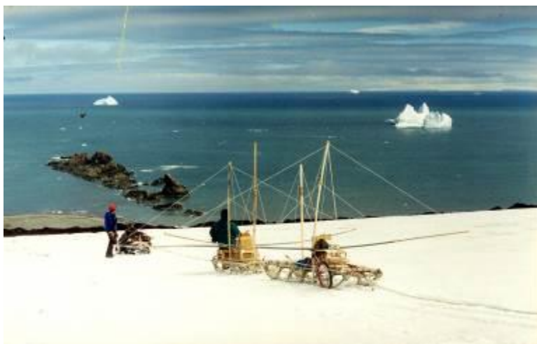
Рис. 12. Локатор ВИРЛ-2. Применялся в 1999 и 2000 годах для зондирования ледника Альдегонда на Шпицбергена и ледников Джонсонс Хард на острове Ливингстон.
