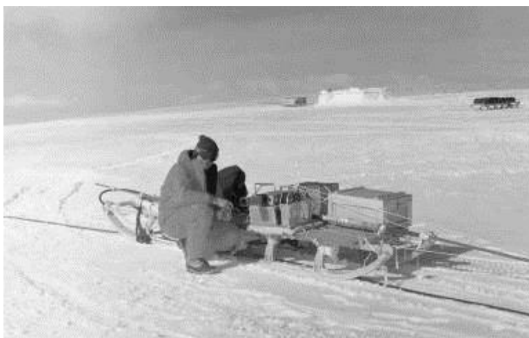
Рис. 11. Локатор ВИРЛ-1. Применялся в 1995-1988 годах для наземного зондирования ледниковых куполов на островах Кинг-Джордж и Галиндес в Антарктике.
