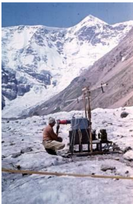
Рис. 3. Измерения с радиовысотомером РВ-10 на леднике Безенги на Кавказе, 1970 год.
