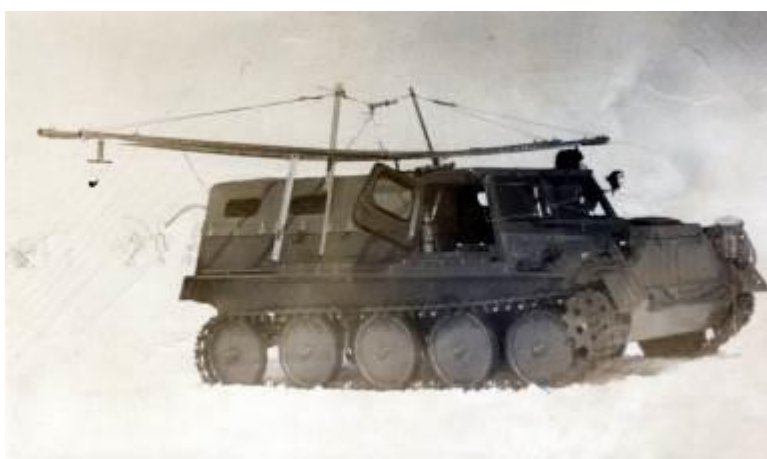
Рис. 2. Антенны радиовысотомера РВ-10 на вездеходе. Полярный Урал, 1968 г.
