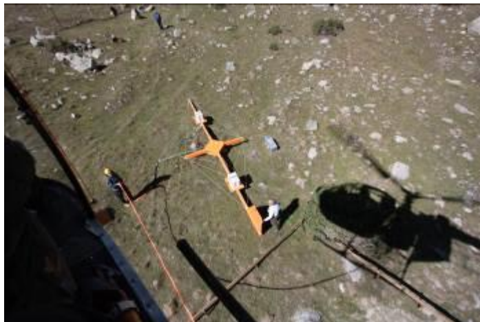
Рис. 16. локатор ВИРЛ-6 на вертолетной ферме. Применялся в 2012-2014 годах для аэрозондирования ледников Большого Кавказа и Эльбруса.
