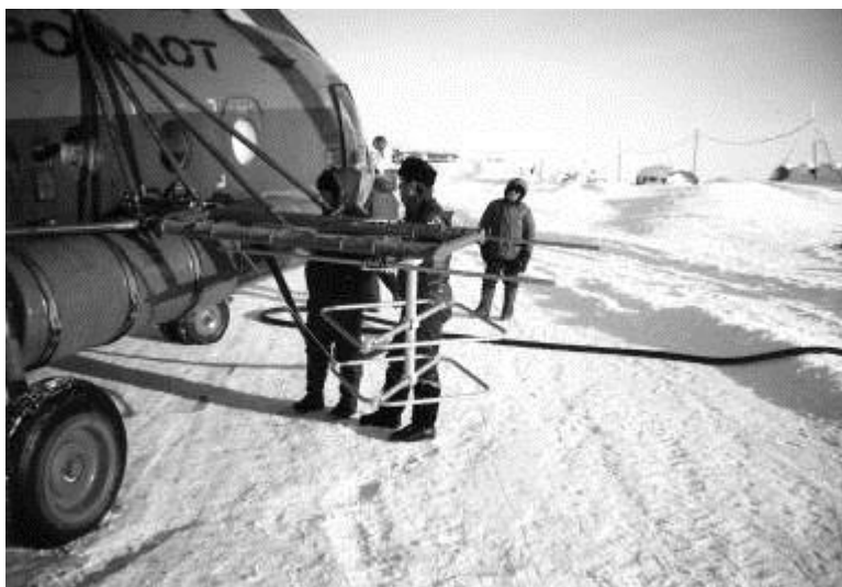
Рис. 10. Антенны 100 МГц локатора на борту вертолета Ми-8, остров Средний Северная Земля. Локатор с такими антеннами применялся в 1997 году для аэрорадиозондирования ледников Северной Земли.
