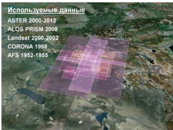
Рис.7. Пример покрытия территории Горного Алтая материалами разновременных космических съемок.
